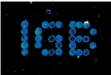
Bild 1: Fluoreszierende Nanopartikel im Mikrometermaßstab auf einem Chip angeordnet, gesehen mit einem Fluoreszenz-Scanner.
