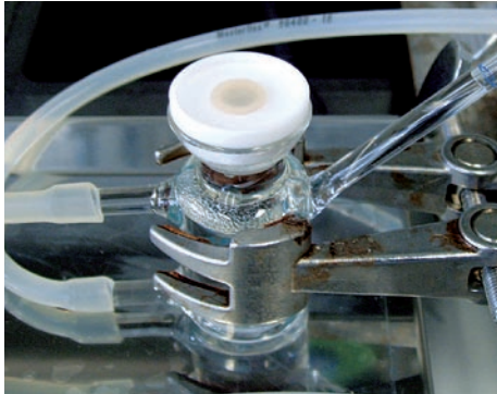
Bild 1: Aufbau einer Franz-Zelle mit einem 3-D-Hautmodell zur herkömmlichen Testung der Biokompatibilität.
