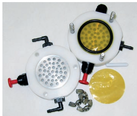
Bild 1: Messzelle zur Bestimmung der Ethanolpermeabilität mit Kompositmembranen.
